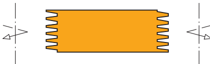
Profil 1 mit durchgehender Verzinkung
