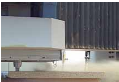
Trennen von Arbeitsplatten mit DP-Oberfräsern. Konventioneller Oberfräser: Spänestrahл tritt horizontal aus und durchschießt Bürsten- oder Lamellenvorhänge.
