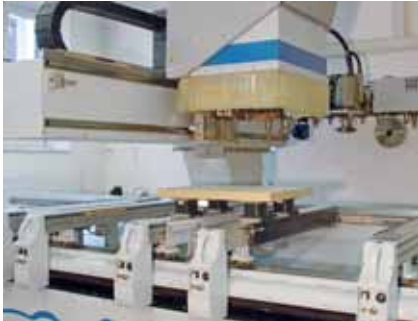
CNC-Bearbeitungszentrum in Ausleger-Bauweise mit Konsolentisch.
