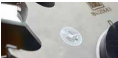
Werkzeug mit integriertem Datenträger.
