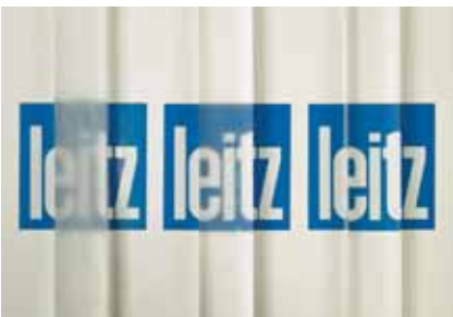
Glanzgefräste Fläche an PMMA-Werkstück
