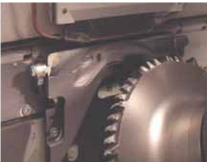
Problem: Maschinenverschleiß durch abrasive Späne.
