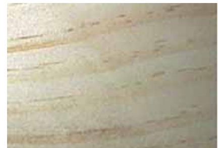
Fertig gehobelte Oberfläche nach Vorhobeln mit RipTec.
