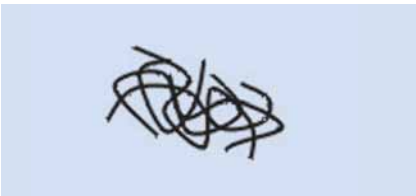
Knäuelbildung der Polymere bei Thermoplasten (Prinzipdarstellung)
