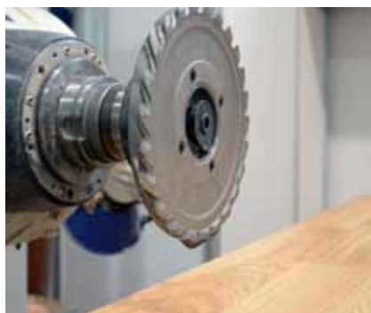
DFC®-Werkzeug für gerichteten Spänestrahl. DFC®-System: Werkzeug mit angepasster Absaughaube. Der größte Teil der Späne wird erfasst und der Verschleiß von der Maschine ferngehalten.
