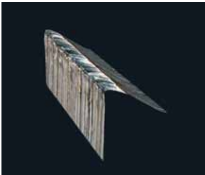
Scharfkantiger Verschleiß an einer beschichteten HS-Schneide
