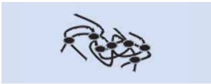
Struktur von Duroplasten (Prinzipdarstellung)
